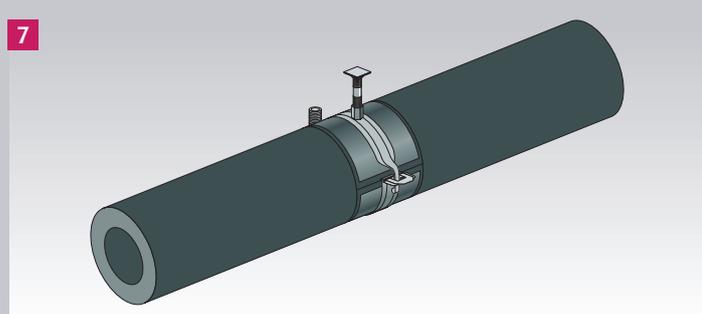
Montageabschluss nach sicherer, diffusionsfreier Verklebung
