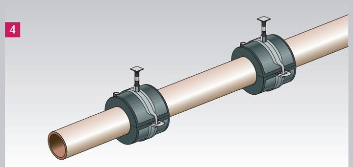
Rohrträger IF mittig in/unter die Rohrschelle schieben und die IF-Rohrschelle mit der seitlichen Schraube festziehen ...
