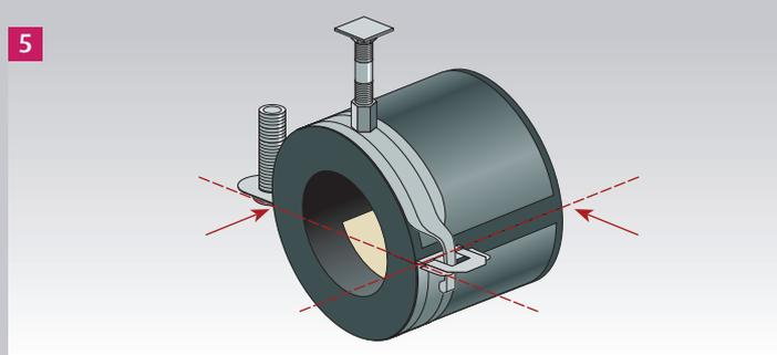
Die Naht der einseitigen IF-Rohrträgeröffnung liegt immer horizontal, unabhängig von der Position der Schellenverbindungen ...
