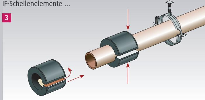
Rohrträger IF – Schutzfolien von Klebeflächen abziehen, um das Rohr fixieren und zusammenkleben ...
