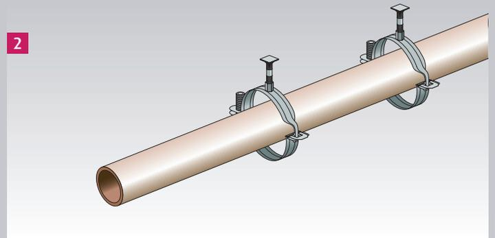
Rohr in die Schellen einlegen (siehe Abb. 1 a/b) und positionieren ...
